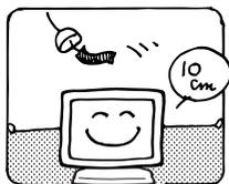
通風孔をふさぐと内部に熱がこもり、火災の原因となることがあります。風通しをよくするために、モニタは周囲から10cm以上離して置いてください。スタンドを取り外して使用するときも、モニタ背面の通風孔をふさがないように十分なスペースを確保してください。
